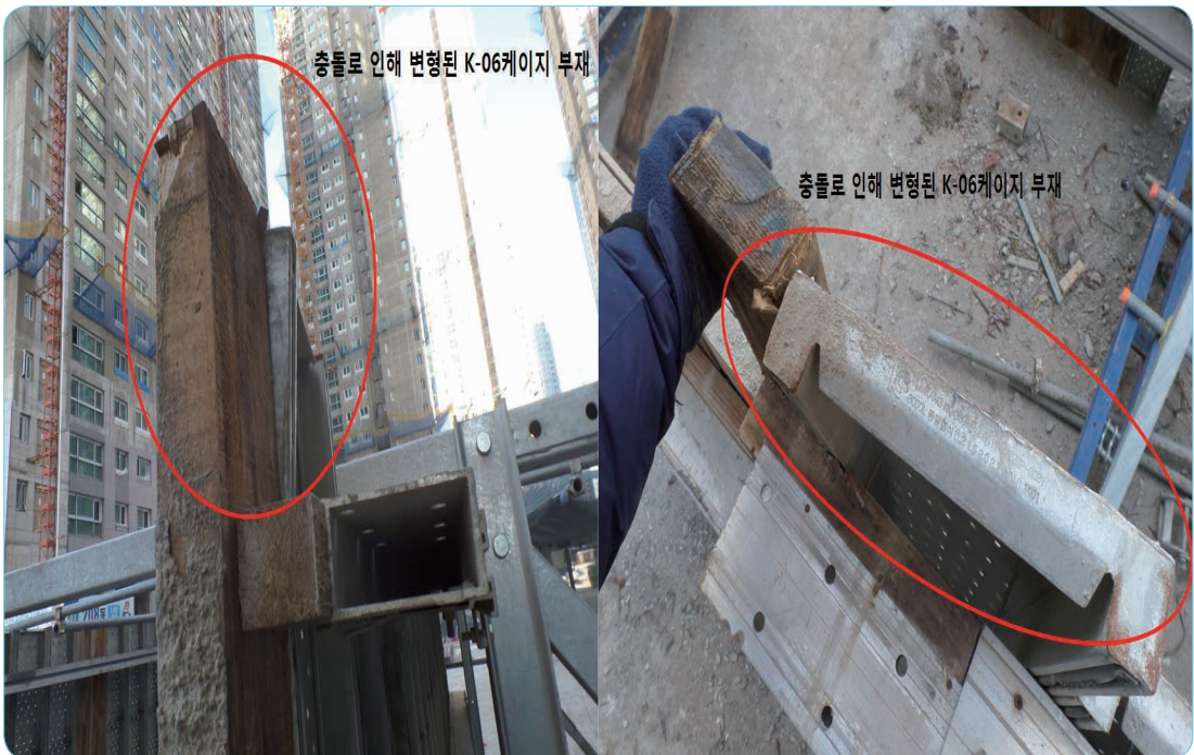
[사진2] 재해조사당시 G.C.S품의 손상부위 모습
